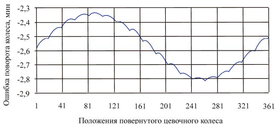
Рис. 6. Полный угол поворота (ошибка угла поворота) цевочного колеса
